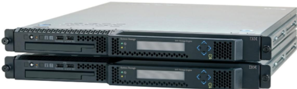
Каждый узел SVC представляет собой сервер с предустановленным программным обеспечением виртуализации, обеспечивающим функционал кэширования и перемещения данных. Узлы объединяются парами, образуя группы ввода-вывода (IO Group). В каждой группе ввода-вывода кэш-память обоих узлов зеркалируется для повышения отказоустойчивости системы, а также балансируется нагрузка между всеми портами ввода-вывода. Группы ввода-вывода могут объединяться в единый кластер (до 8 узлов, 4 группы ввода-вывода).
