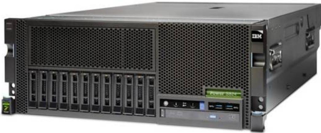
Данная система, предназначенная для решений среднего уровня, базируется на процессоре IBM Power8. Архитектура этого процессора объединяет до 12 ядер, площадь кристалла – 640 мм<sup>2</sup>. Процессоры выпускаются по технологии 22нм. Данная система может быть 1- или 2-хсокетной.
