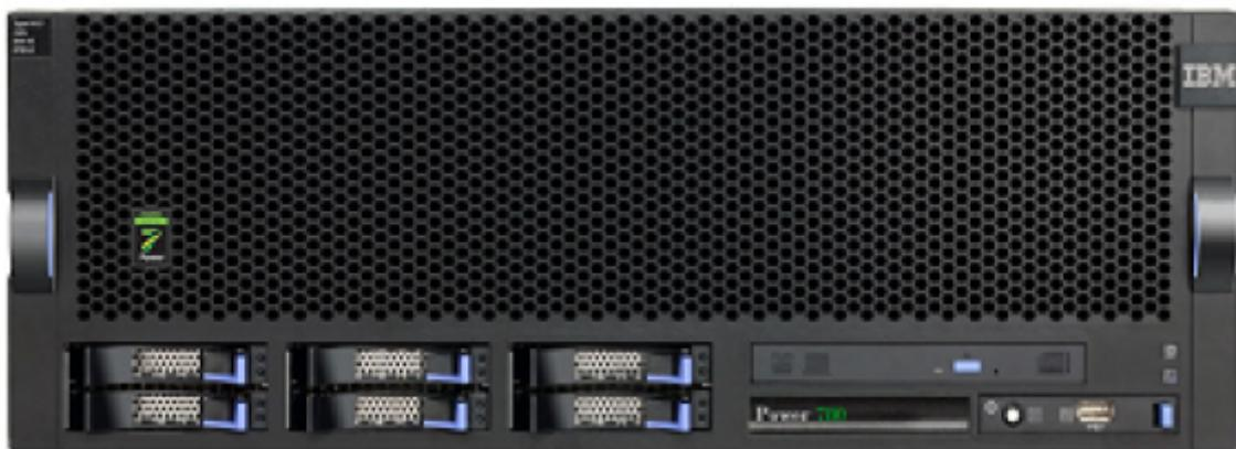
Данная система, предназначенная для решений среднего уровня, базируется на процессоре IBM Power7+, площадь кристалла – 567 мм<sup>2</sup>. Процессоры выпускаются по техпроцессу 32нм. Есть 2 варианта процессора для IBM Power 780: с 4 ядрами с частотой 4,42 ГГц или 8 ядрами с частотой 3,72 ГГц.
