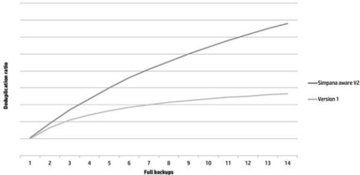
Система хранения РК HPE StoreOnce позволяет повысить коэффициент дедупликации CommVault по сравнению с хранением резервных копий на традиционных NAS файловых серверах (внутреннее тестирование HP).
