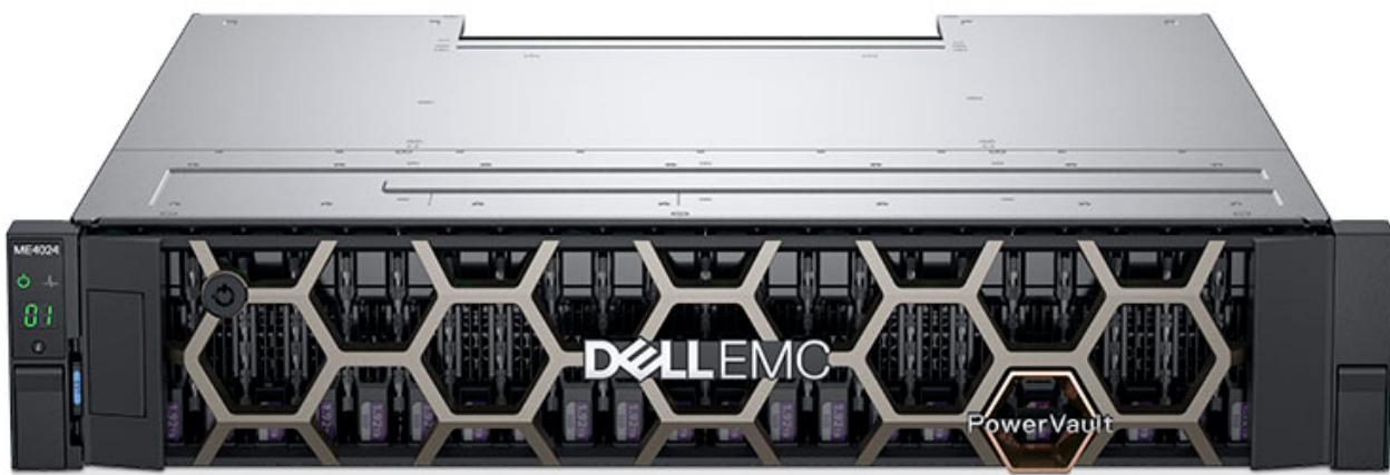
PowerVault ME4 это SAN и DAS система хранения начального уровня. Поддерживаются протоколы FibreChannel 16Gb/s, iSCSI 10Gb/s или SAS 12Gb/s. Не смотря на свою низкую стоимость данная СХД достаточно высокой производительностью и всем необходимым функционалом, который всегда и весь включен в состав системы:
