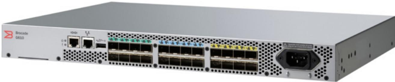
Коммутатор шестого поколения Brocade G610 оснащен 24 портами стандарта Fibre Channel 32Gbps и предназначен для монтажа в стойку.
