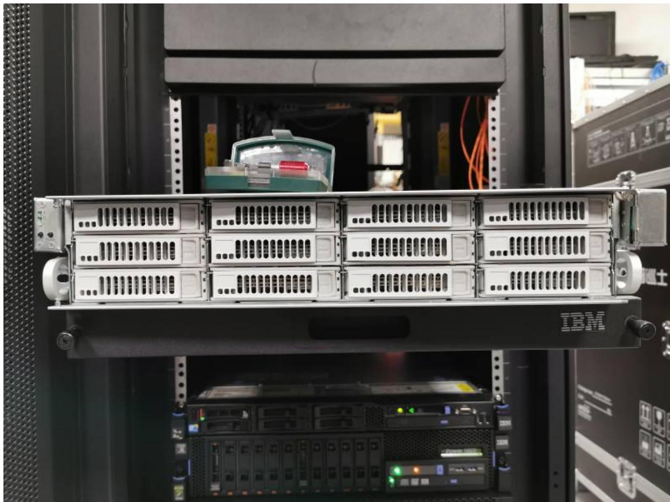
12 отсеков расположены за лицевой фальшпанелью и доступны без снятия крышки сервера.
