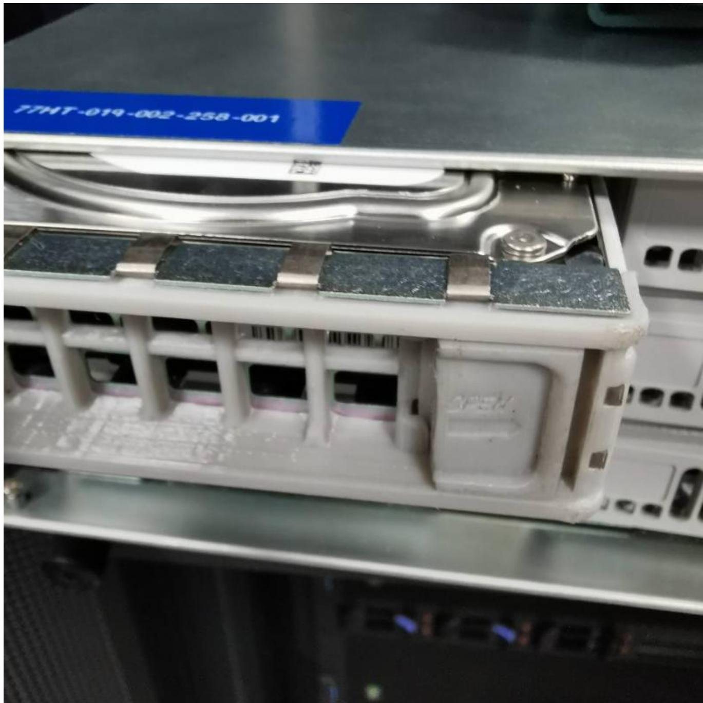
Салазки для жестких дисков лицевой панели оригинальные - напечатанные на 3D принтере. Скорее всего для печати был использован пластик с высокой температурой плавления, например ABS. Печать из данного материала достаточно сложна в домашних условиях, поэтому на детали видна "рябь".
