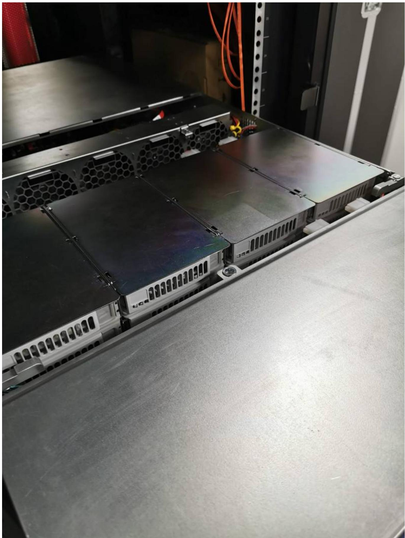
Обслуживание остальных 12 отсеков производится только при снятой крышке корпуса. Диски размещены внутри сервера.
