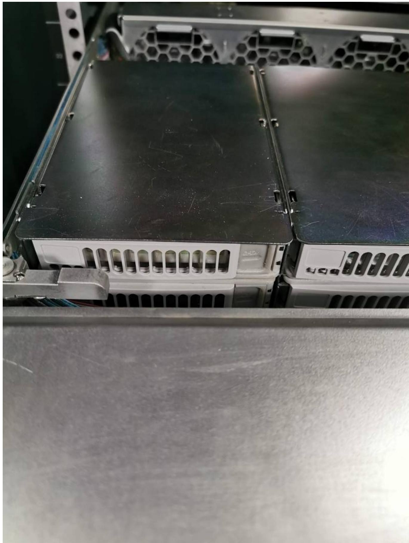
Диски, скрывающиеся в глубине корпуса оснащены комбинированными салазками. Рама и кнопка выполнены методом 3д-печати, ручка промышленного производства.
