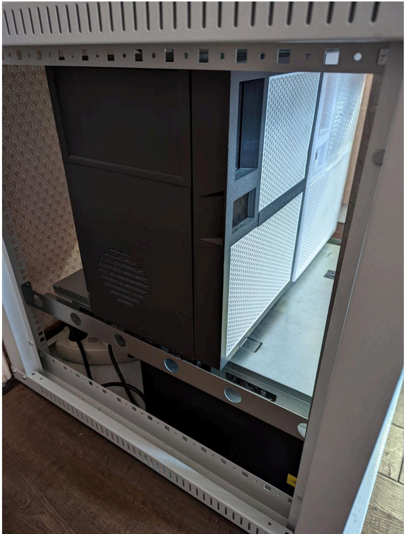
Корпус сервера в сборе занимает чуть более 7U в высоту, поэтому места на "полочку", ИБП и серверы в данном шкафу хватает "впритык".
